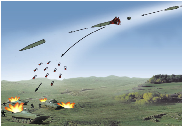
Funktionsweise eines Kanistergeschosses
